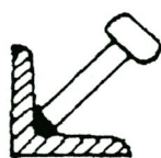
Kopfbolzen in einer Winkelecke
